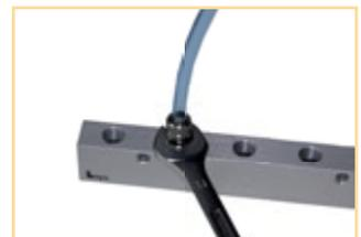
Apertar a porca totalmente, à mão (no caso de um tubo flexível) e à chave (no caso de um tubo semi-rígido) até ao contacto com o corpo.
