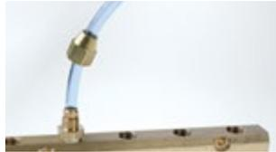
Colocar o tubo encostado à saliência do corpo da conexão e pré-apertar à mão.
