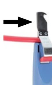
5. Deslocar a ferramenta para a extremidade do tubo para realizar a abertura axial do revestimento.
