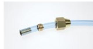
É recomendado usar um insert no tubo (para diâmetros maiores que 14 mm), para evitar que o tubo deforme.
