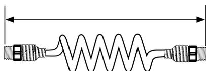
Comprimento útil (em mm)
