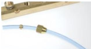
Fazer deslizar a porca no tubo; lubrificar a rosca do corpo, a anilha e a rosca da porca para facilitar o aperto (idem para a versão inox); montar a anilha na extremidade do tubo.
