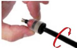
*O facto de centrar e rodar o conector facilita a passagem no gas block do cabo de fibras óticas mais grosso admissível.*
