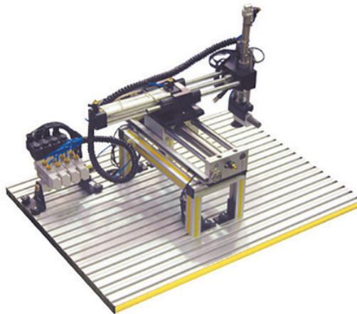
Este manipulador é constituído por um sistema de três eixos cartesianos realizando movimentos por meio de atuadores pneumáticos com sistema de guias lineares. O sistema está montado através de interfaces mecânicas sobre uma mesa perfilada com tampo de alumínio perfilado, possibilitando a montagem dos módulos de comando. Os atuadores possuem sensores magnéticos com terminal tipo pino banana de 4 mm para a comunicação com eletroválvulas e módulos elétricos.
