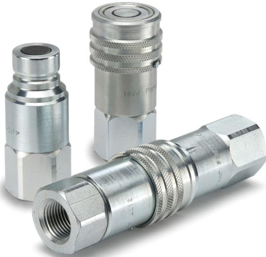
Os engates face plana da série FEM atendem ou excedem os requisitos de design e desempenho da ISO 16028. O sistema de face plana elimina vazamento de fluido hidráulico assim como a entrada de ar durante a conexão e a desconexão. Os niples série FEC permitem conexão sob pressão para a pressão acumulada residual.
