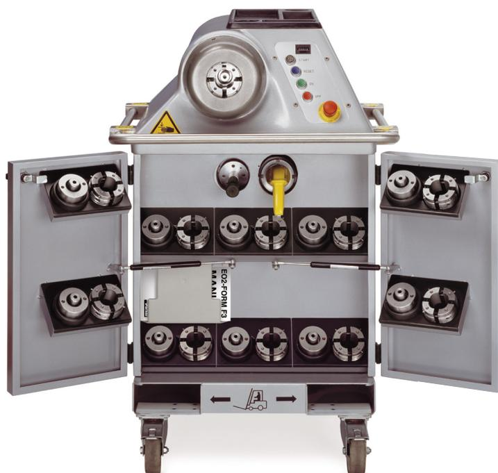
Aplicáveis em interligações de tubos de aço carbono ou inox, as soluções EO2-Form e Parflange F37, dispensam a utilização de solda e o processo de cravamento manual, eliminando o risco de erros de montagem, além de reduzir o tempo de instalação, custo de manutenção e inspeção garantindo alta performance contra vazamentos.
