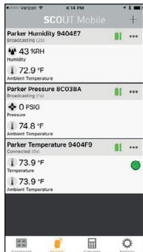
Acesse com um toque os sensores que foram adicionados ao seu dispositivo móvel com suas medições mais recentes, status de alarme e modo do sensor - transmissão ou conexão
