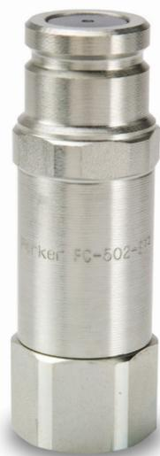
Os niples face plana da série FC operam de forma ligeiramente diferente dos tradicionais engates anti vazamento. Sem pressão no engate, oferecem a opção do acoplamento sob pressão para pressões acumuladas de até 3000 psi no lado do niple.
